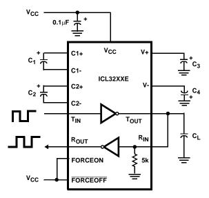
FIGURE 12. TRANSMITTER LOOPBACK TEST CIRCUIT
