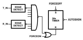
FIGURE 7. ENHANCED AUTOMATIC POWERDOWN LOGIC
