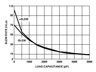
FIGURE 16. SLEW RATE vs LOAD CAPACITANCE
