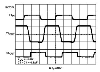
FIGURE 14. LOOPBACK TEST AT 1Mbps (C<sub>L</sub> = 250pF)
